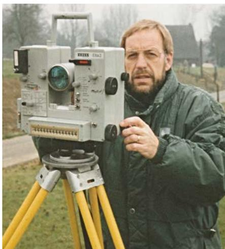
Der selbstregistrierende Tachymeter „Elta 2“ von Zeiss Oberkochen war der „Gerätestar“ der 80er und 90er Jahre. Er wurde beim Vermessungs- und Katasteramt des HSK bis etwa zum Jahr 2000 eingesetzt.
