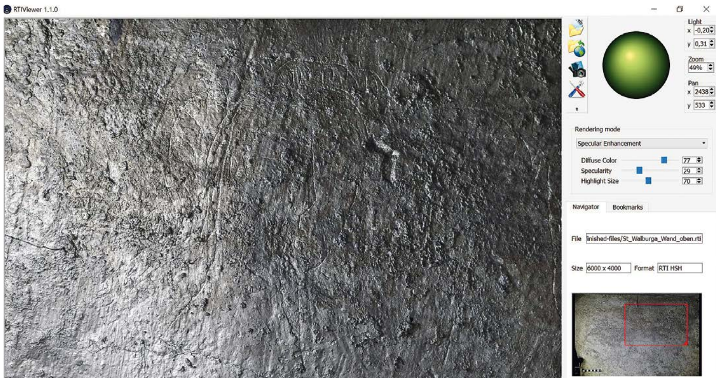
Abb. 2: Mit dem RTI-Viewer können im Digitalen unterschiedliche Ausleuchtungen erprobt werden. Die Beleuchtungsrichtungen sind anhand der grünen Kugel am rechten Bildrand des Programms frei wählbar.
